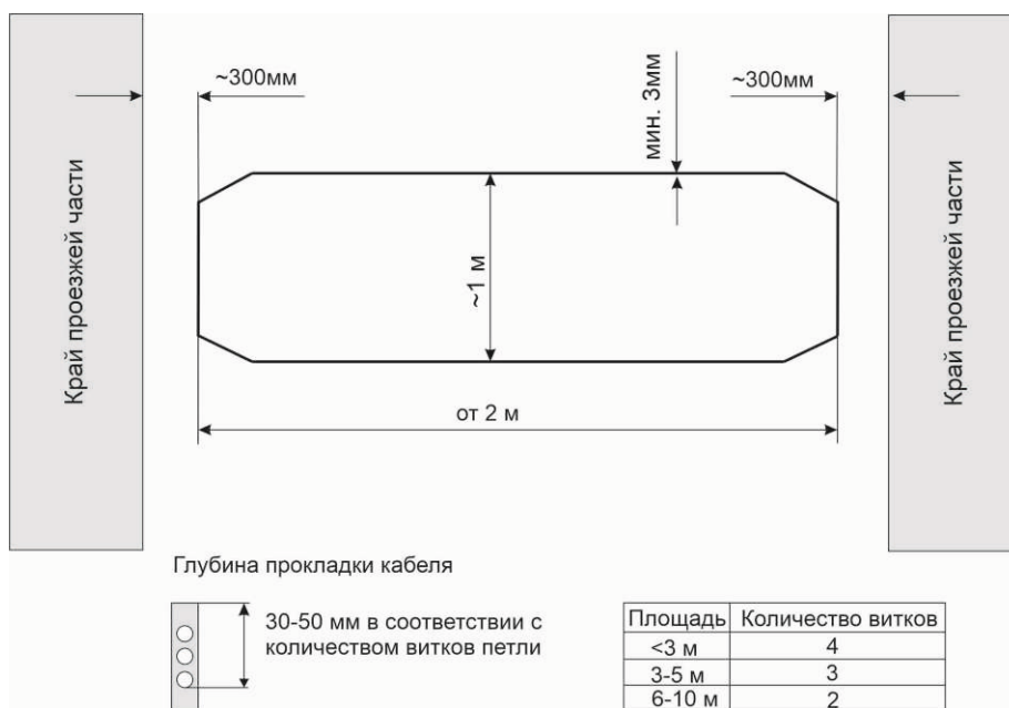
Рисунок 6.9.2.2 Схема монтажа петли
