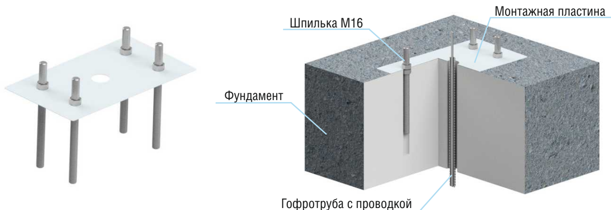
Рисунок 7.2.1 Устройство фундамента с монтажным комплектом
