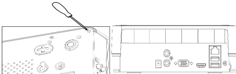
Рисунок 2.1 Демонтаж крышки регистратора
