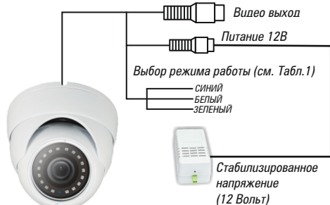
Рис.1 Схема подключения
